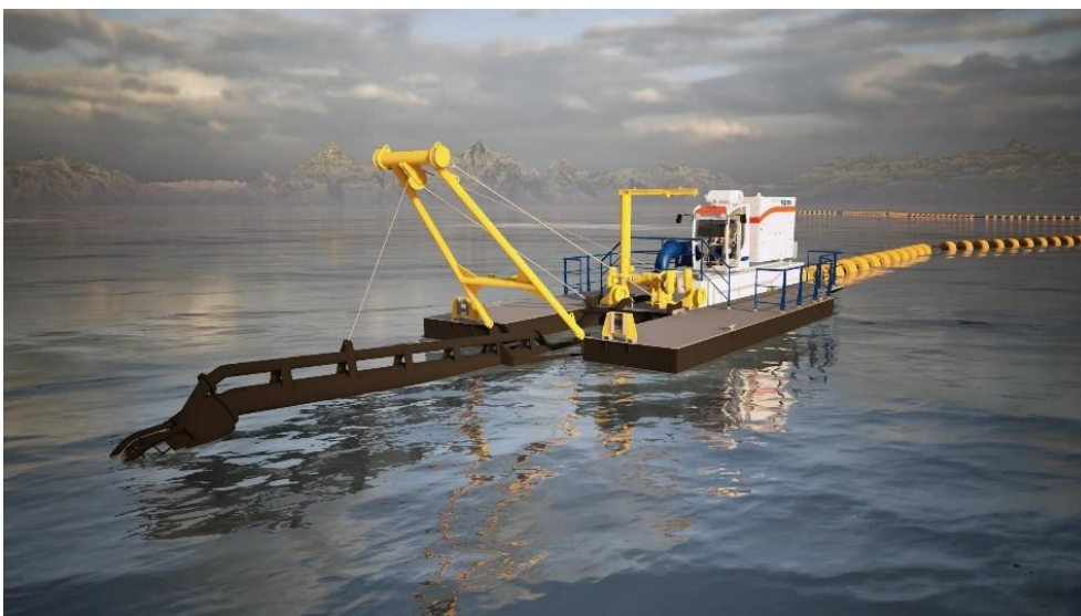
Slika 3-15: Primjer običnog usisnog jaružala
