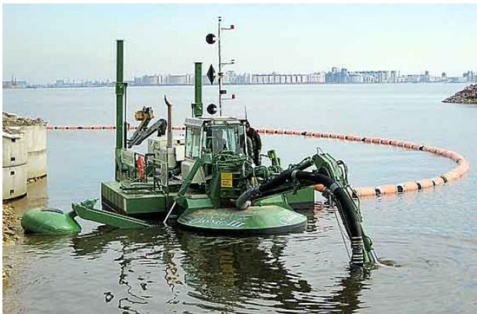
Slika 3-8: Primjer samohodnog usisnog jaružala
