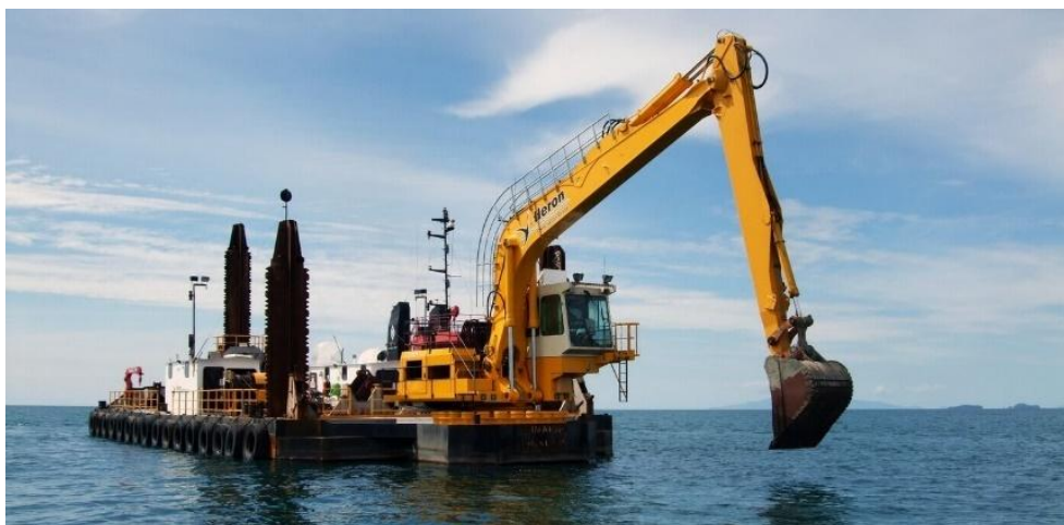
Slika 3-12: Primjer jaružala s dubinskom lopatom
