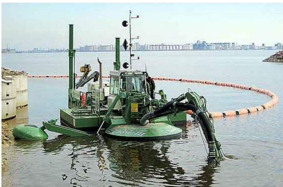
Slika 3-16: Primjer samohodnog usisnog jaružala
