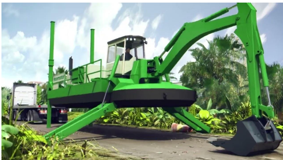
Slika 3-13: Primjer samohodnog jaružala s dubinskom lopatom
