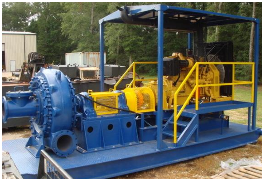
Slika 3-9: Primjer „booster“ crpke
