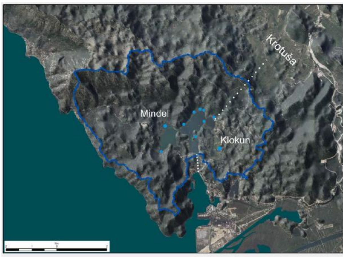
Grafički prikaz 4-14: Površinski sliv Baćinskih jezera označen tamno plavom linijom (prikazan u DOF5, Državna geodetska uprava). Određen je pomoću ArcGIS-a (ESRI, 1999-2009). Izvori su prikazani plavim krugovima, a tuneli točkastim linijama.
