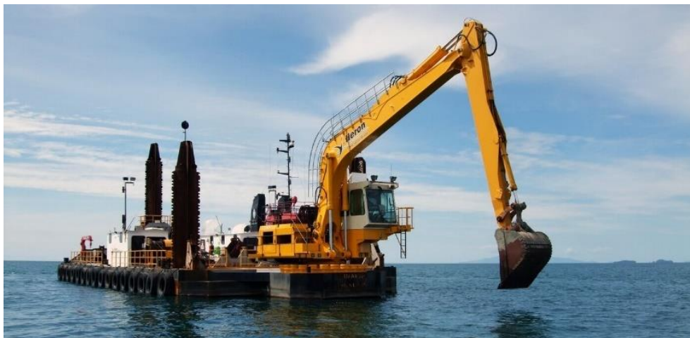
Slika 3-12: Primjer jaružala s dubinskom lopatom
