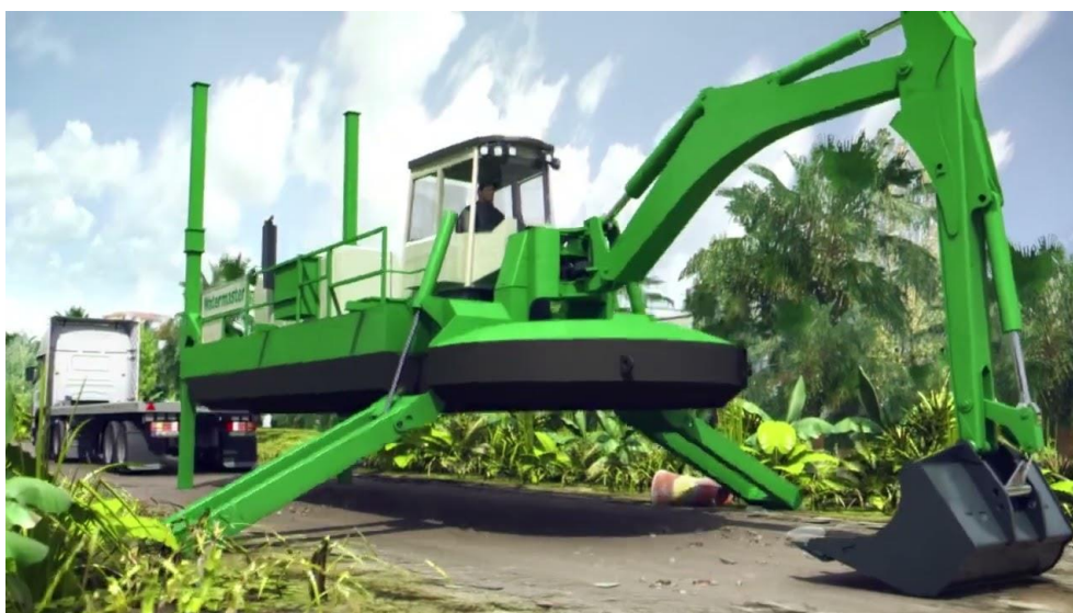
Slika 3-13: Primjer samohodnog jaružala s dubinskom lopatom
