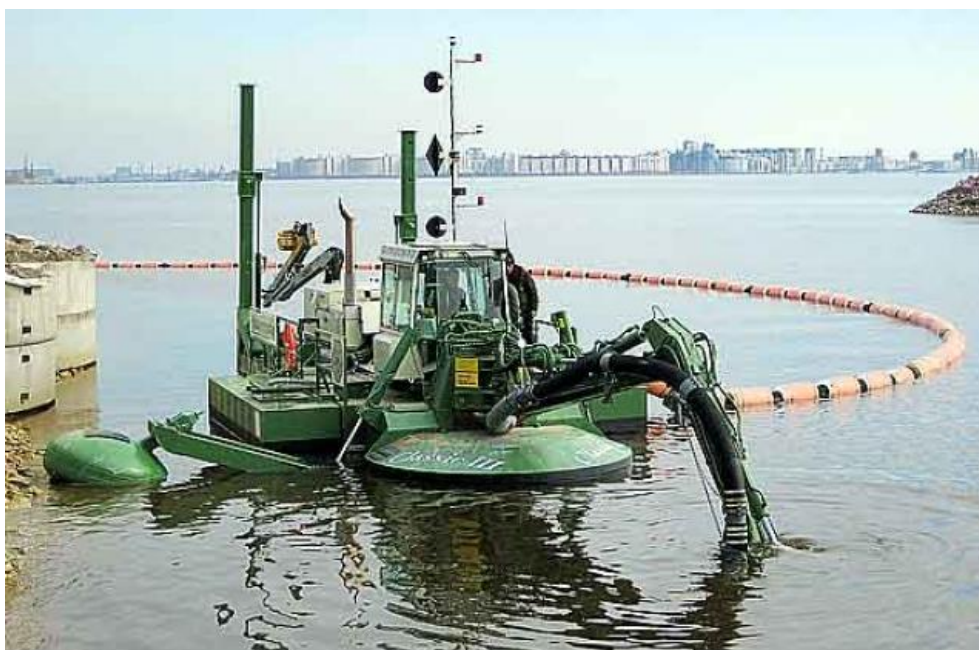
Slika 3-16: Primjer samohodnog usisnog jaružala
