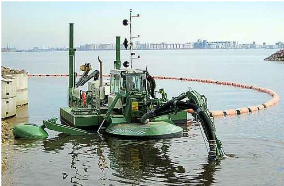
Slika 3-8: Primjer samohodnog usisnog jaružala
