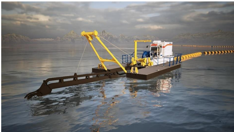
Slika 3-15: Primjer običnog usisnog jaružala
