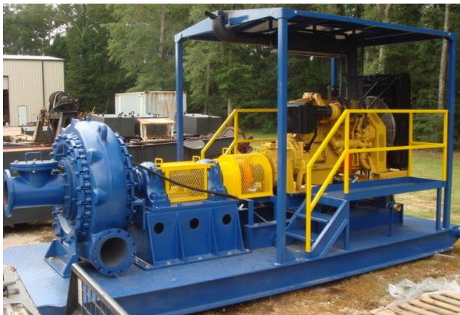
Slika 3-9: Primjer „booster“ crpke
