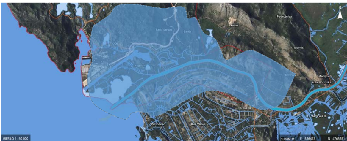
Slika 18: Područje maksimalnog plavljenja u donjem toku Neretve na području grada Ploča Izvor podataka: Planovi i Procjene j.d.o.o.
