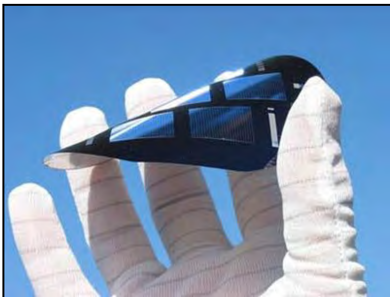
Slika 10. Sunčana FN ćelija izrađena tehnologijom tankog filma
