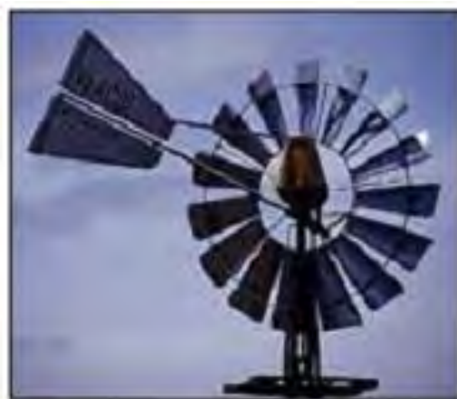
Slika 16. Vjetroagregat s više lopatica
