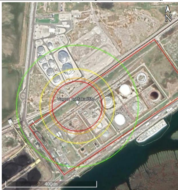
Slika 25. Zone ugroženosti uslijed eksplozije para benzina na lokaciji vagon pretakališta
