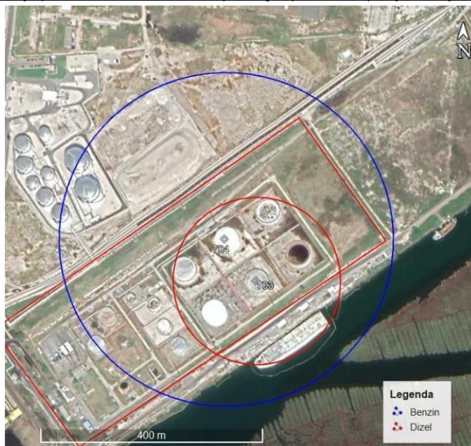
Slika 24. Zone ugroženosti izlijevanje benzina i dizela u okoliš (bez nastanka požara/eksplozije)
