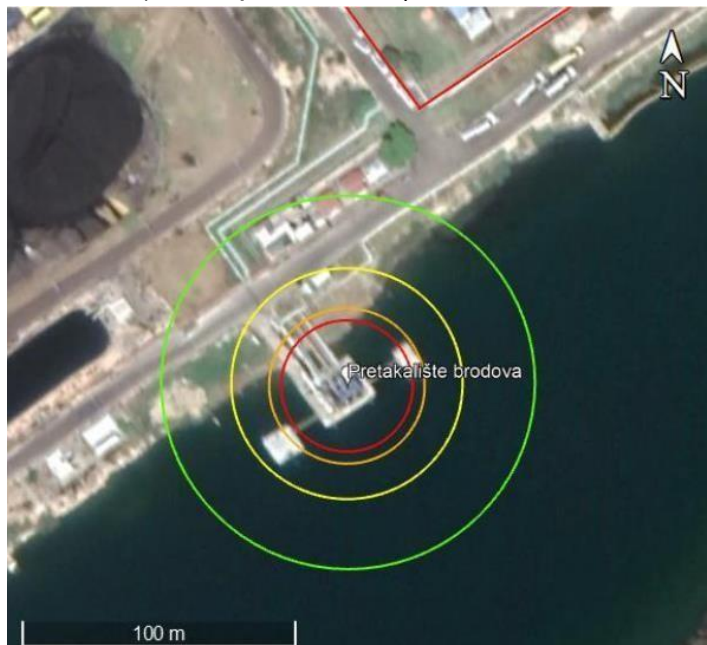
Slika 27. Zone ugroženosti uslijed eksplozije para benzina zbog loma utakačke ruke na lokaciji pretakališta brodova
