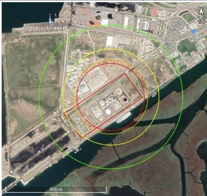
Slika 21. Zone ugroženosti uslijed eksplozije para benzina
