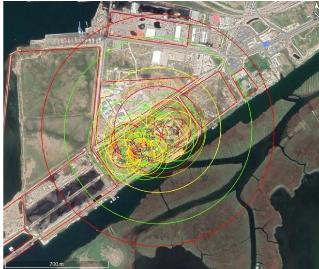
Slika 29. Zona ugroženosti uslijed unutarnjeg domino efekta
